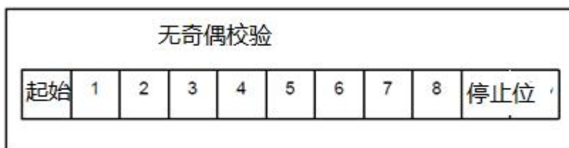
图 4-1：RTU 模式下的位序列
